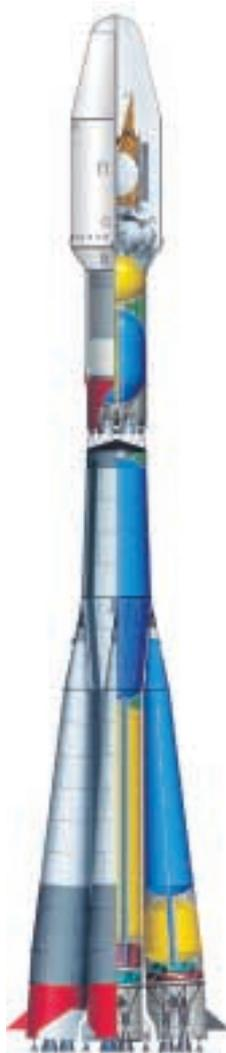
РН «Союз-2», как все ракеты этого семейства, выполнена по схеме с параллельным отделением боковых ракетных блоков в конце работы первой ступени и поперечным отделением ракетного блока второй ступени по окончании его работы.
