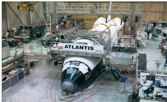
товке к полету, осмотрен второй двигатель главной установки и осуществлена проверка компьютеров системы обработки информации, являющейся частью системы управления орбитального полета.
