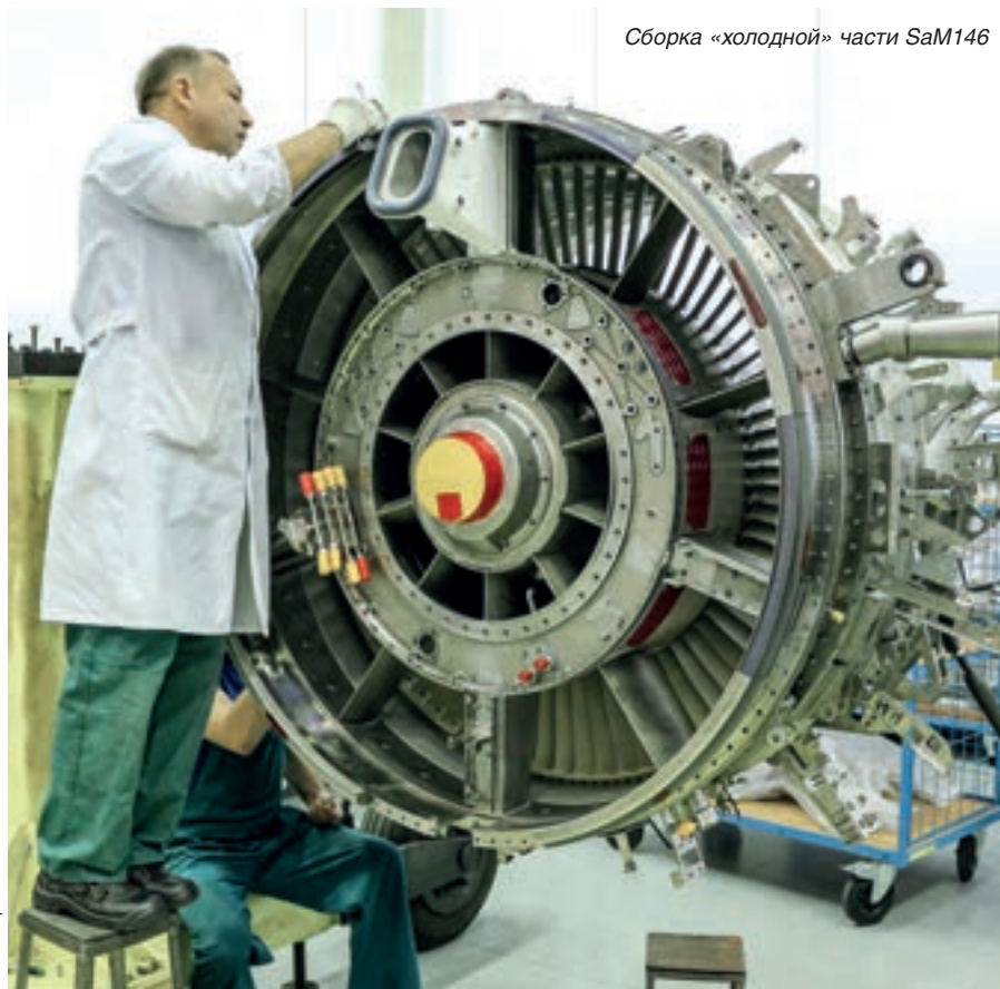
Модуль вентилятора с бустером двигателя ПД-14, изготавливаемый на «Сатурне»
