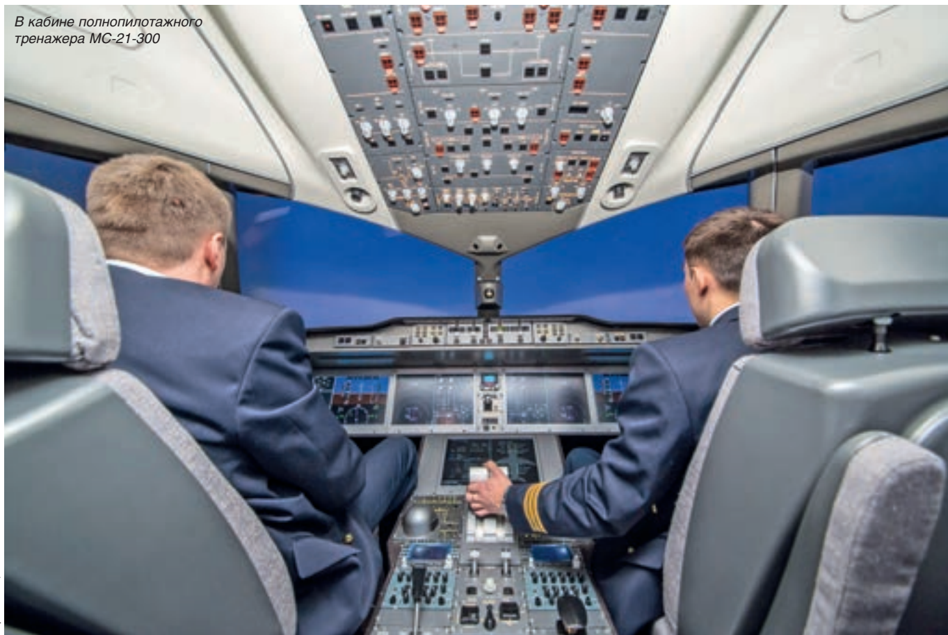
Процедурный тренажер MC-21-300 в Центре подготовки авиационного персонала «Аэрофлота». На заднем плане – FFS самолета SSJ100
