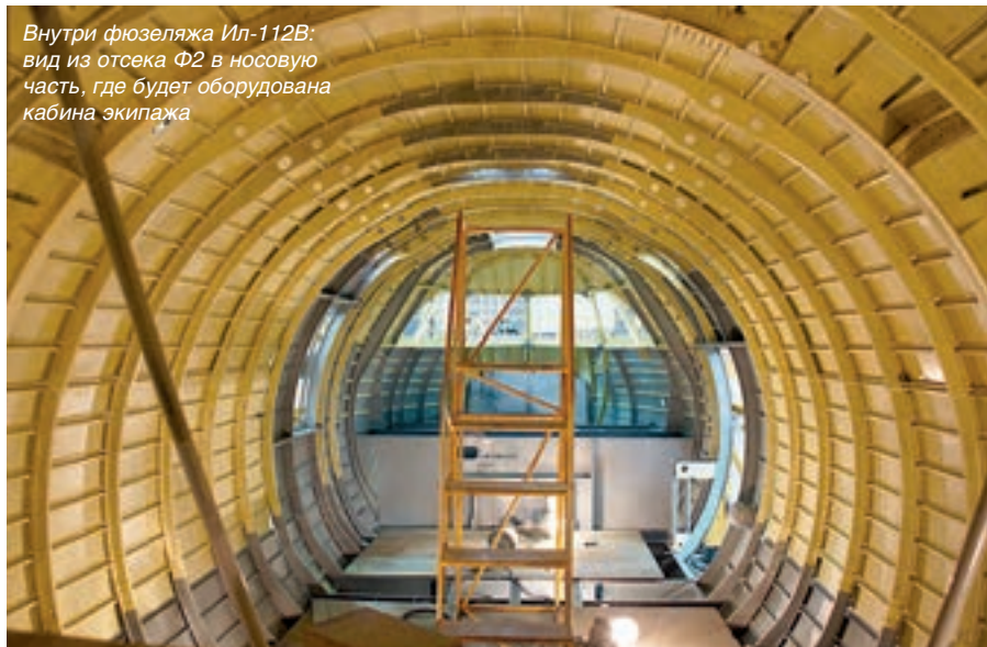
Заключительные операции стыковки фюзеляжа Ил-112В №0101
